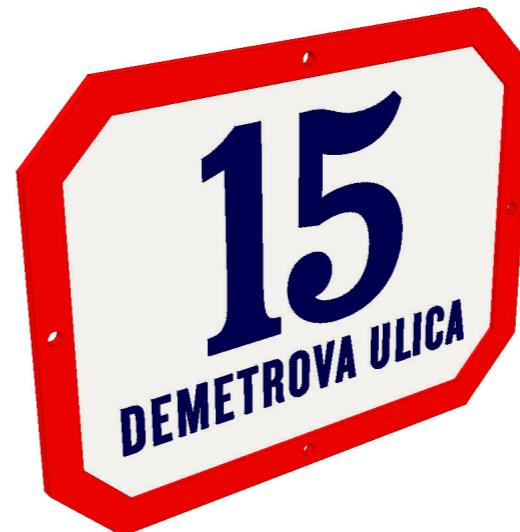
Materijal: silumin, cink i špijater ili slični trajni materijal. Dimenzija ploče je  $325 \times 250 \times 3,5$  mm. Rub oko ploče debljine je 20 mm. Sama ploča debljine je 5 mm te odrezanih čoškova pod  $45^\circ$  dužine 60 mm. Slova su izbočena 3 mm, a brojevi 5 mm. Ploča je lakirana u RAL9010, s rubom RAL3000, te slovima i brojem u RAL5003. Pločica se za podlogu montira vijcima koje je potrebno nakon montaže obojati bojom podloge kako ne bi bili uočljivi.
