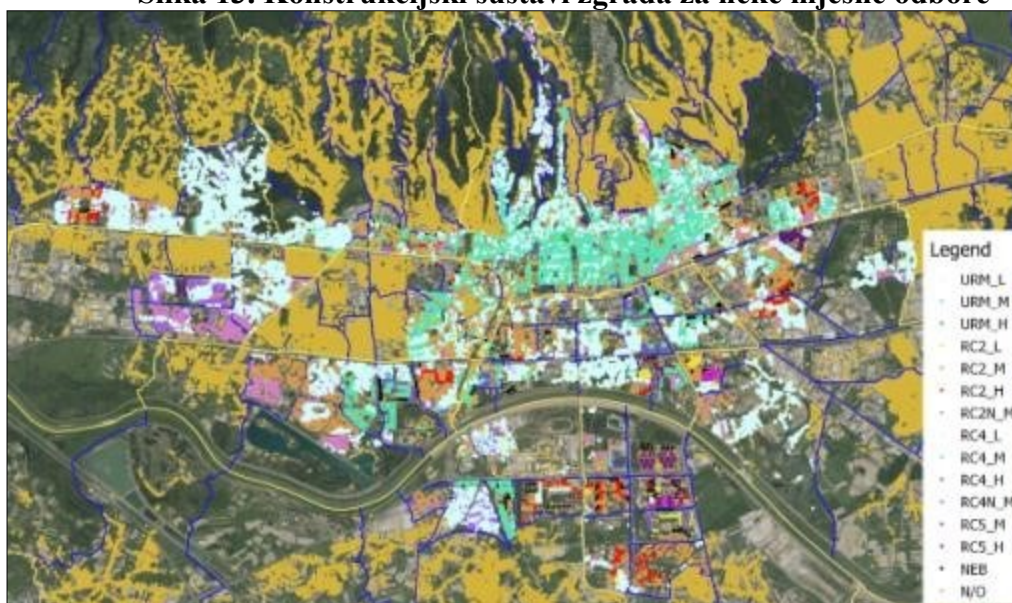
Slika 13. Konstrukcijski sustavi zgrada za neke mjesne odbore
